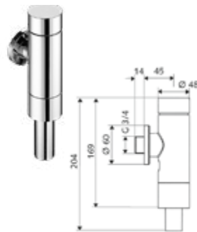
DIANA O100 WC-Druckspüler mit Drucktaste 3/4", mit Messing-Drucktaste für 1 Spülmenge, Spülmenge einstellbar 4,5 - 9 l, konform DIN EN 12541, verchromte Ganzmetallausführung, DN 20, (DI041113500)
