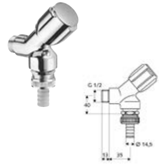
DIANA Geräteschrägsitzventil 1/2" mit RB ohne ASAG Sicherungskombination gem. EN1717 mit Rückflussverhinderer, Belüfter und Schlauchverschraubung, Prüfzeichen P-IX 007/1, DVGW zertifiziert, Dimension DN 15 G 1/2 AG, verchromt, (DI407910500)
