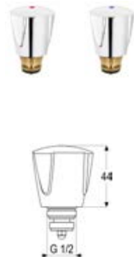
DIANA O100 Sanitär Oberteile mit Metallgriff G 3/8" kalt, verchromt, (DI407781500K) G 3/8" warm, verchromt, (DI407781500W) G 1/2" kalt, verchromt, (DI407782500K) G 1/2" warm, verchromt, (DI407782500W)
