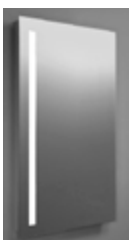
DIANA S100 LED-Leuchtspiegel mit Schalter und Lichtstreifen rechts oder links 1 Lichtstreifen vertikal/senkrecht, 2,5 cm breit, 5 cm eingerückt, rechts oder links. Seitliche Mon- tage- und Sichtschutzleisten aus Edelstahl hochglanzpoliert mit Kippschalter, Elektronik und LED-Lichttechnik austauschbar (4.000 Kelvin), EEK E, 800 x 400 x 32 mm, Linksausführung, (DI662101) 400,- € Rechtausführung, (DI662102) 400,- €
