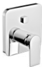
DIANA M100 Unterputz Wannen- und Brausemischer Feinbauset, PUSH&SWITCH Druckumsteller, Keramik-Kartusche mit Heißwasserbegrenzung, Eigensicher gegen Rückfließen, Durchflussmenge 25 l/min bei 3 bar, verchromt, für Flexx.Boxx2 *, (DI405662500) 434,- €
