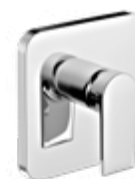
DIANA M100 Unterputz Brausemischer Feinbauset, Keramik-Kartusche mit Heißwasserbegrenzung, Durchflussmenge 25 l/min bei 3 bar, verchromt, für Flexx.Boxx2 *, (DI405610500) 262,- €
