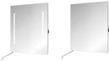
DIANA C100 Kippspiegel 20° Neigungswinkel, inkl. 2 verschieden seitlichen Satinierungen 15 x 600 mm mit 4.000 Kelvin, 14,4 Watt, inkl. 2 verschiedener Hebellängen, ohne Schalter, IP 20, 600 x 800 mm mit Beleuchtung, (DI617440500) 1.014,- € ohne Beleuchtung, (DI617442500) 718,- €
